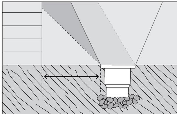
2. Eine 30cm tiefe Drainage aus Kies vorsehen. Leuchte lose im Kiesbett positionieren. Oberen Rand der Leuchte bündig OKFF ausrichten. Den Anschluss der Zuleitung nicht unmittelbar neben dem Leuchtengehäuse vornehmen, sondern im Abstand von mindestens 1 m. Mitgeliefertes Installationsrohr zum Schutz vor Beschädigungen über die Anschlussleitung bis Wasserstopper schieben.
