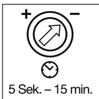
Stufenlos einstellbare Leuchtdauer von 5 sek. bis 15 min.
